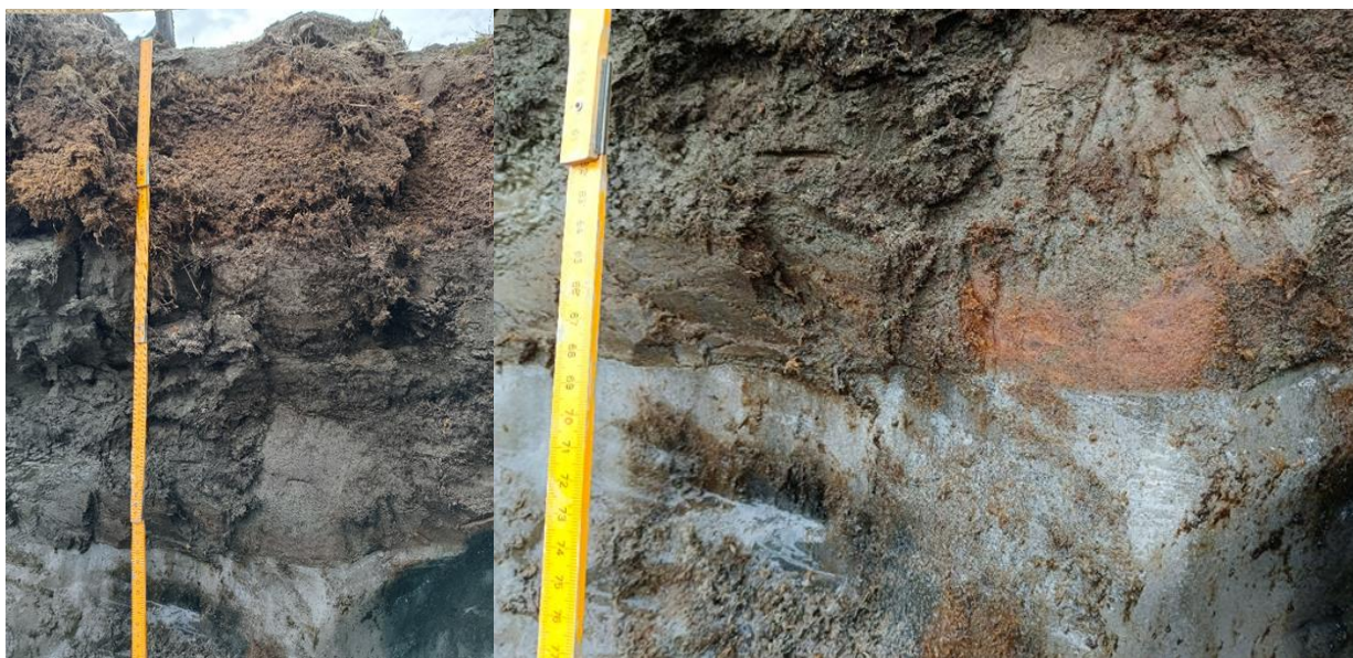
Рис.12. Слева - перекрывающие ПЖЛ отложения: торф – супесь – торф. Справа - верхний контакт повторно-жильного льда с перекрывающим (вмещающим) торфом. Граница чёткая, термокарстово-пещерных льдов и сегрегационной каймы не наблюдается
