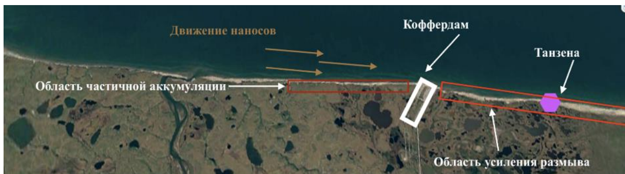
Рис.8. Схема формирования областей аккумуляции и размыва
