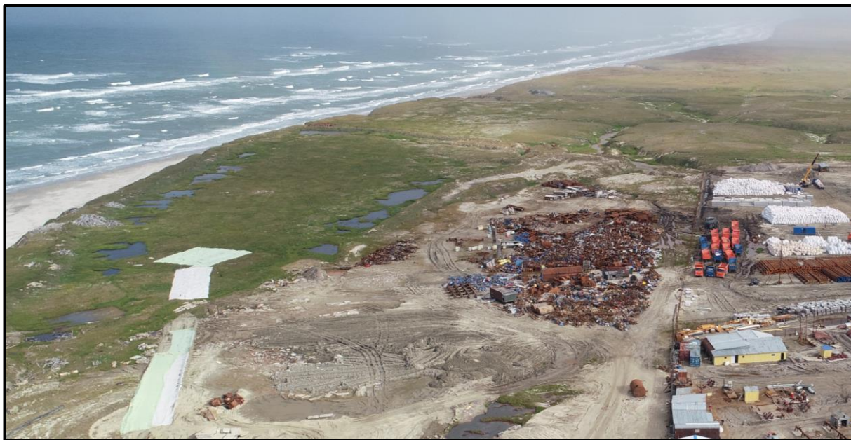
Рис. 8. Техногенно-вызванный термокарст вследствие затрудненного стока вод и свалка металлолома (мыс Харасавэй)
