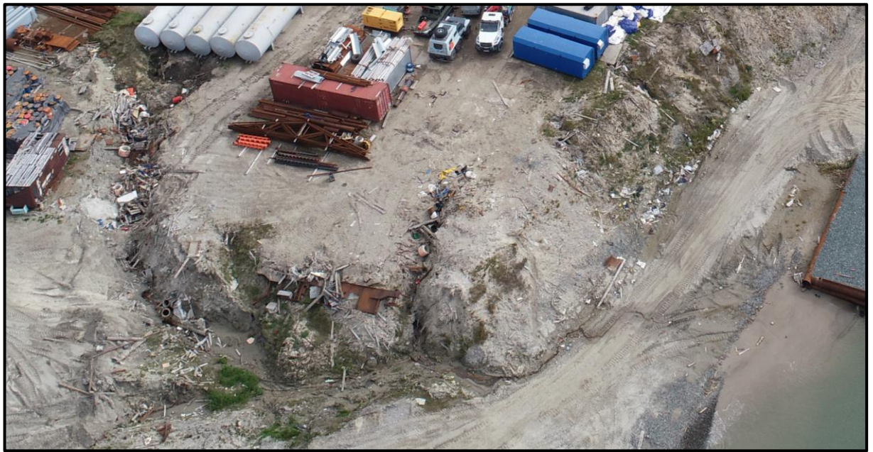
Рис. 9. Засыпка оврага мусором для остановки развития термоэрозии (мыс Харасавэй)
