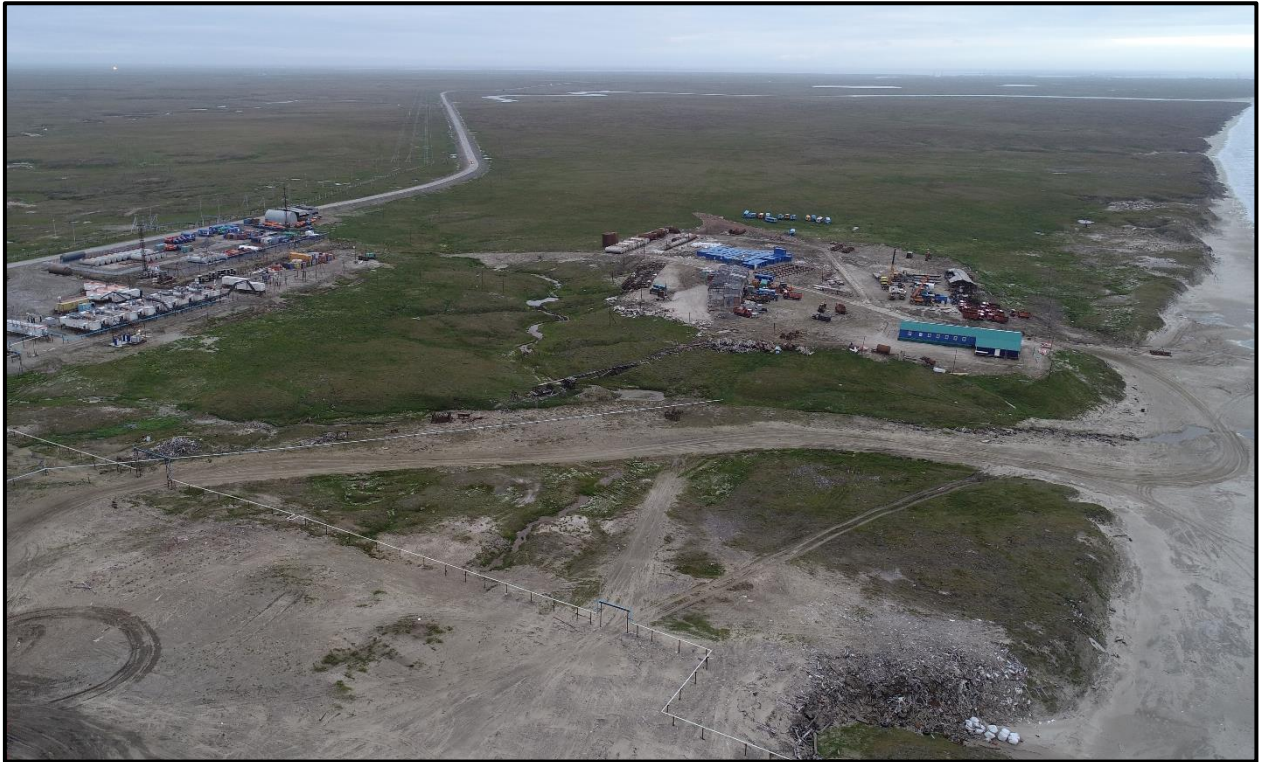
Рис. 13. Вид на дорогу, ведущую в порт. По обеим сторонам дороги развивается термокарст.
